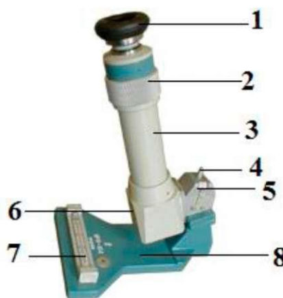
Рисунок 2. Рефрактометр ИРФ 464. 1 - окуляр; 2 - дисперсионный компенсатор; 3 - труба; 4 - рукоятка; 5 - блок рефрактометрический; 6 - винт; 7 - термометр; 8 - стойка
