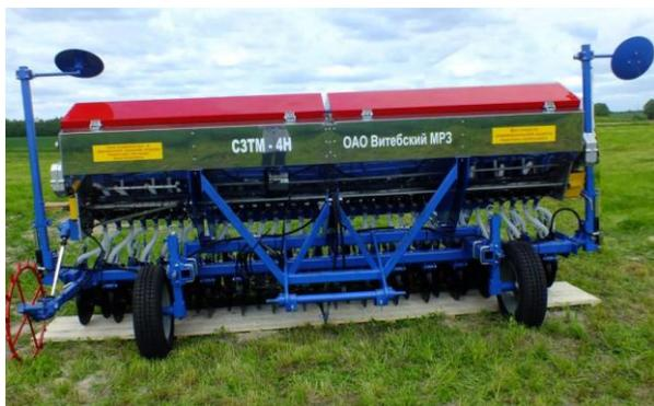
**Рисунок 68 – Машина для внесения минеральных удобрений СЗТМ-4Н**
