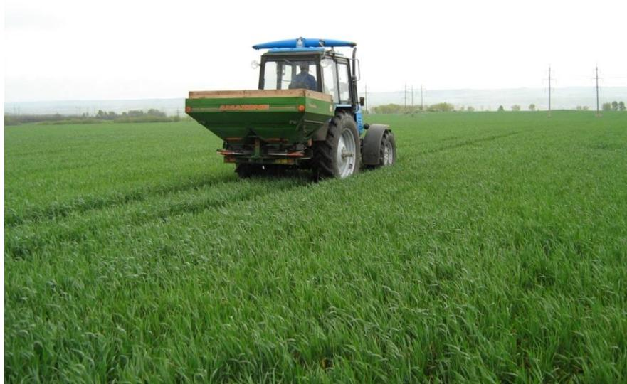
**Рисунок 89 – Разбрасыватель «AMAZONE ZA-M», оснащенный N-сенсором «Яра» для сканирования посева**
