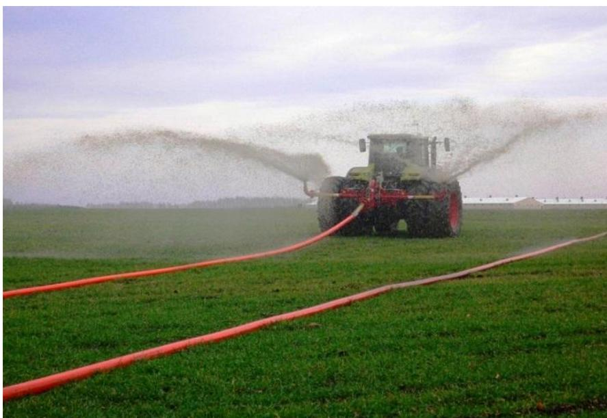
**Рисунок 81 – Поверхностный способ внесения жидкого навоза с использованием шланговых систем**
