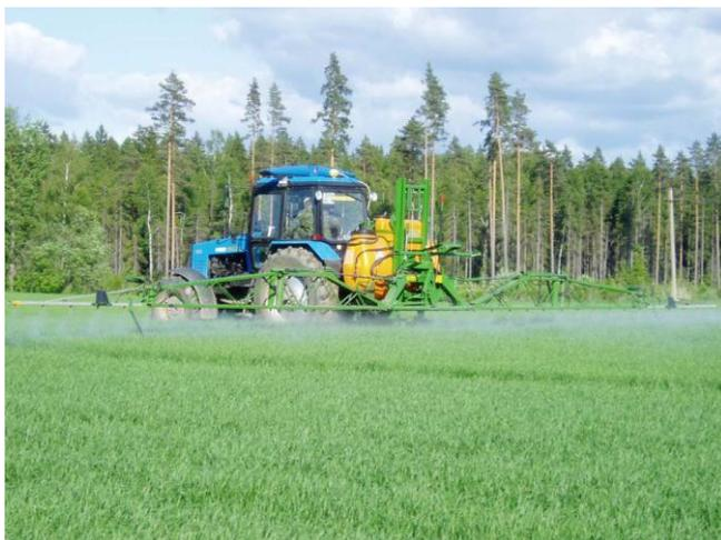
**Рисунок 87 – Навесной опрыскиватель Amazone UF 800**
