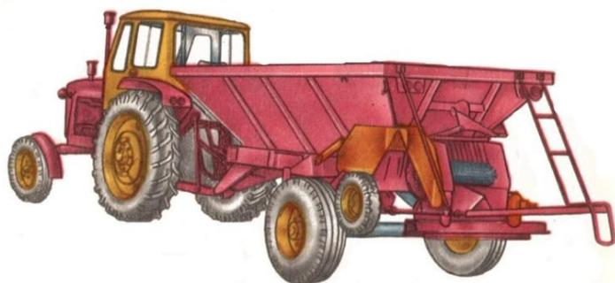
**Рисунок 59 – Разбрасыватель минеральных удобрений 1 РМГ-4**
