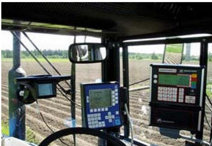
**Рисунок – 88 Оснащение сельскохозяйственной техники в точном земледелии (бортовые компьютеры Amatron II A и Hydro и контролер курса в кабине трактора).**
