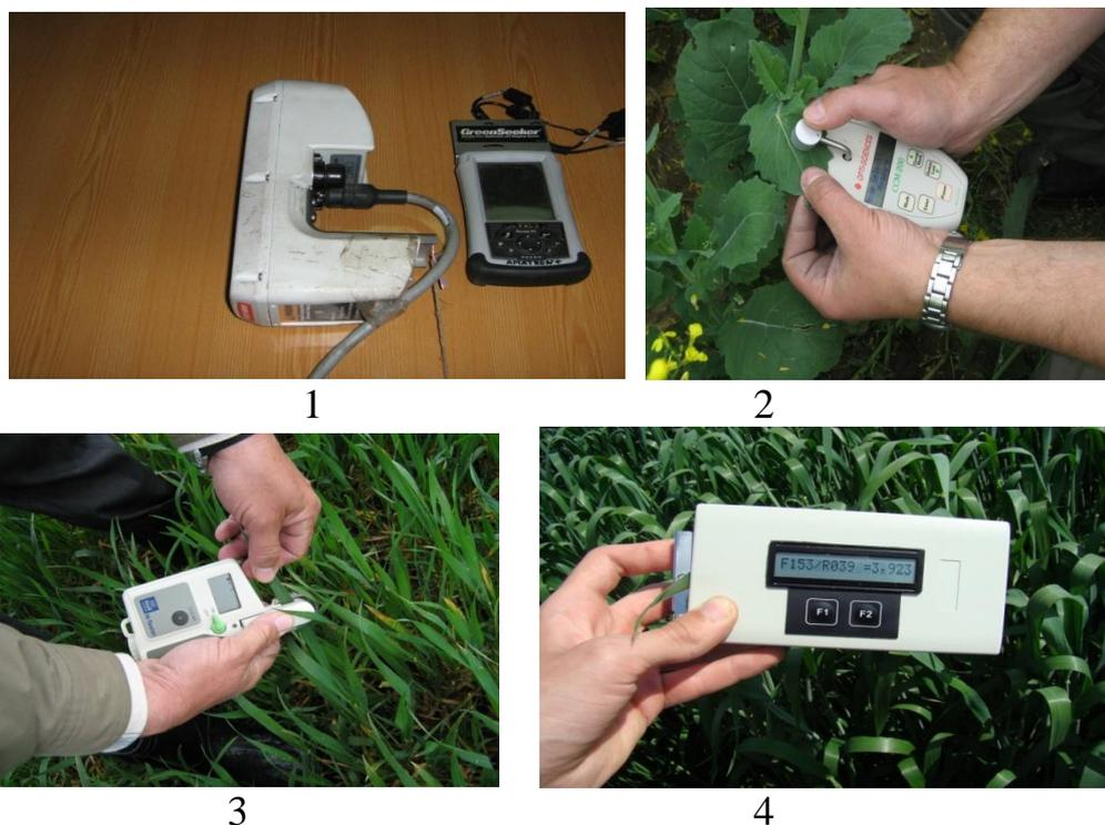
Рисунок 90 – Фотометры: 1 - Оптический датчик GreenSeeker (США); 2 - Американский N-тестер CCM-200; 3 - Портативный N-тестер «ЯРА»; 4 - Портативный N-тестер «Спектролюкс»
