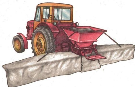
**Рисунок 60 – Разбрасыватель минеральных удобрений НРУ-05**
