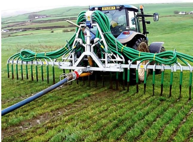
**Рисунок 82 – Поверхностный способ внесения жидкого навоза с использованием низкопрофильного аппликатора**
