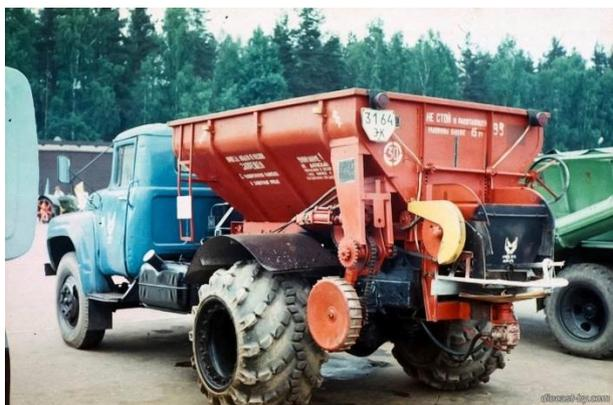
**Рисунок 65 – Автомобильный разбрасыватель минеральных удобрений КСА-3**
