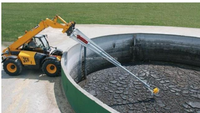
**Рисунок 78 – Передвижная мешалка жидкого навоза**
