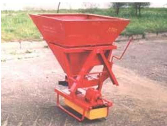
**Рисунок 67 – Разбрасыватель минеральных удобрений Л-116 (Беларусь) Агрегируется с тракторами класса 0,6 и выше**
