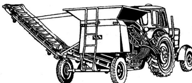
**Рисунок 56 – Агрегат для растаривания и измельчения минеральных удобрений АИР-20**
