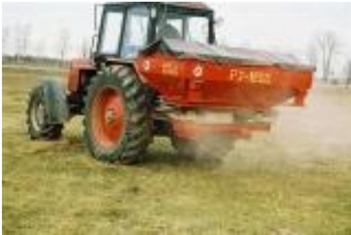
**Рисунок 25 – Рассеиватель минеральных удобрений РУ-1600**
