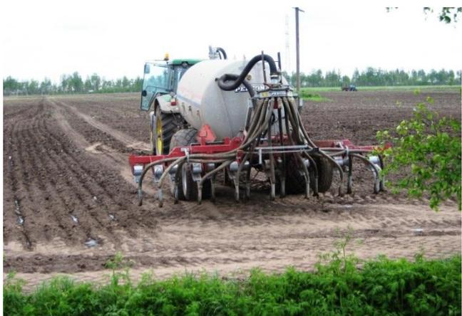
**Рисунок 83 – Внутрипочвенное внесение жидкого навоза**
