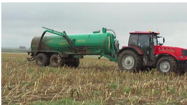
**Рисунок 30 – Машина для внесения жидких органических удобрений МЖУ-20**
