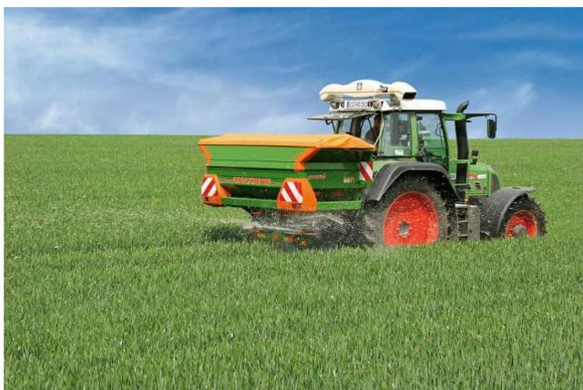
**Рисунок 86 –Центробежный разбрасыватель минеральных удобрений AMAZONE ZA-M 900**
