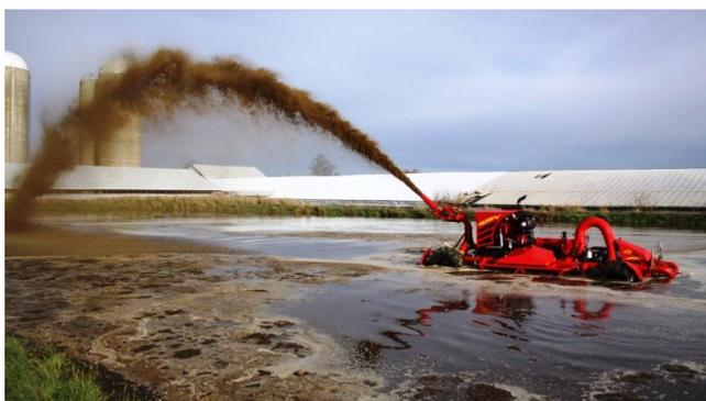
**Рисунок 80 – Лагунная помпа (мешалка-амфибия)**
