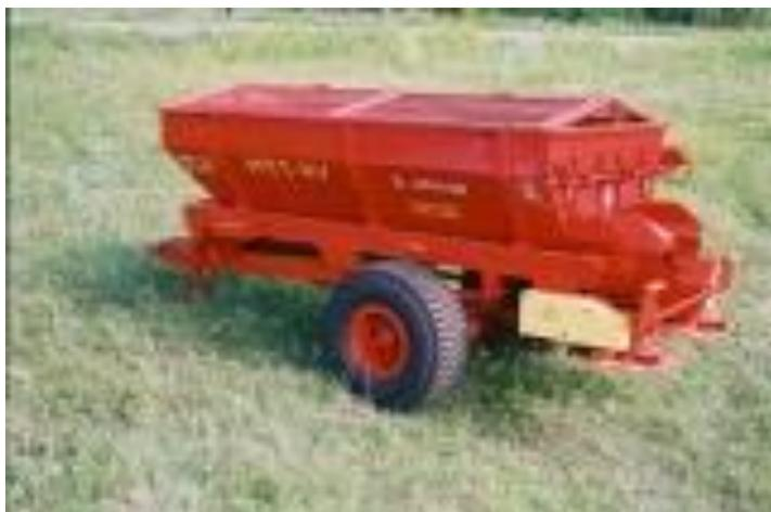
**Рисунок 24 – Машина для внесения твердых минеральных удобрений МТТ-4У (грузоподъемность - 4 т агрегируется с трактором класса 1,4)**
