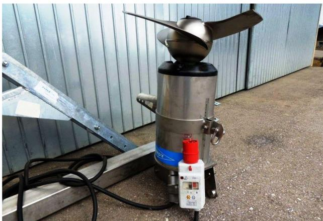
**Рисунок 77 – Стационарная мешалка для небольшой емкости**
