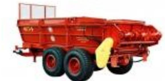
**Рисунок 29 – Машина для внесения твердых органических удобрений МТТ-9**
