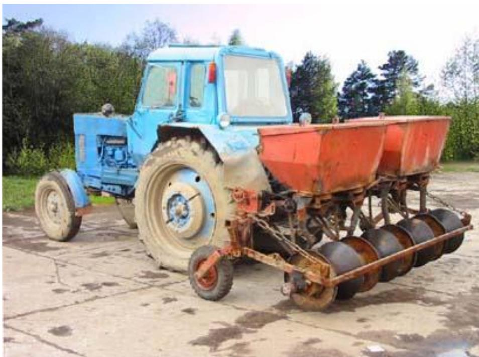
**Рисунок 31 – Агрегат для локального внесения удобрений**
