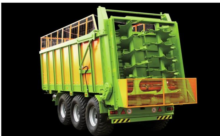
**Рисунок 73 – Разбрасыватель органических удобрений трехосный РОУМ-20, 24**
