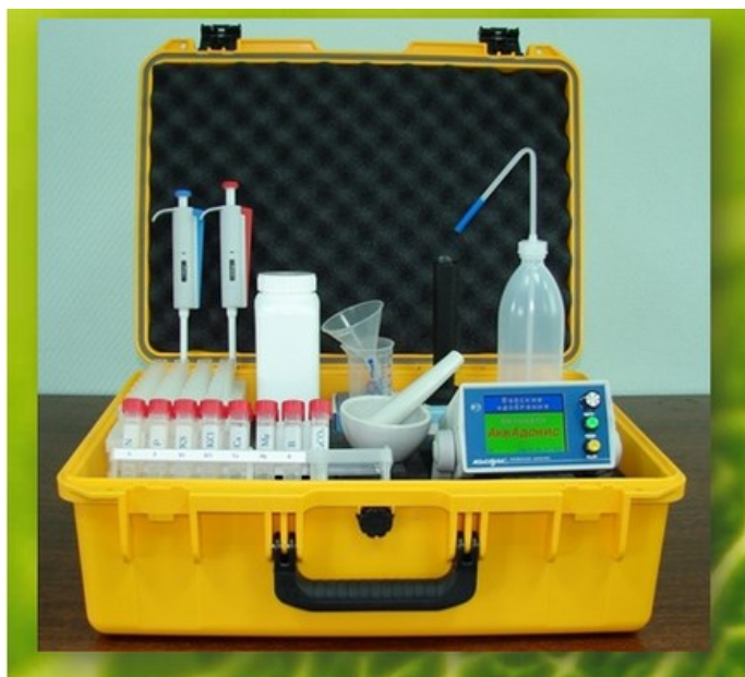
Рисунок 41 – Портативная лаборатория листовой диагностики
