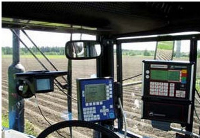
Рисунок 62 – Оснащение сельскохозяйственной техники в точном земледелии (бортовые компьютеры Amatron II А и Hydro и контроллер курса в кабине трактора)
