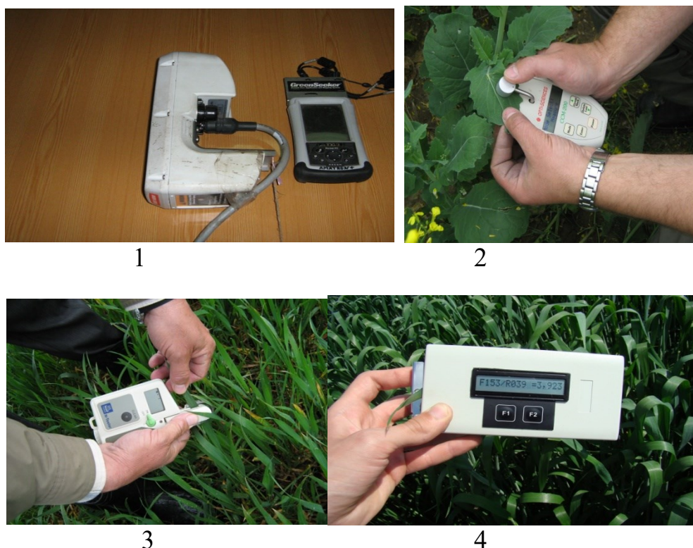
Рисунок 63 – Фотометры: 1 - Оптический датчик GreenSeeker (США); 2 - Американский N-тестер ССМ-200; 3 - Портативный N-тестер «ЯРА»; 4 - Портативный N-тестер «Спектролюкс»
