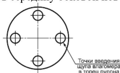
Рисунок 115 – Точки введения щупа в торец рулона
