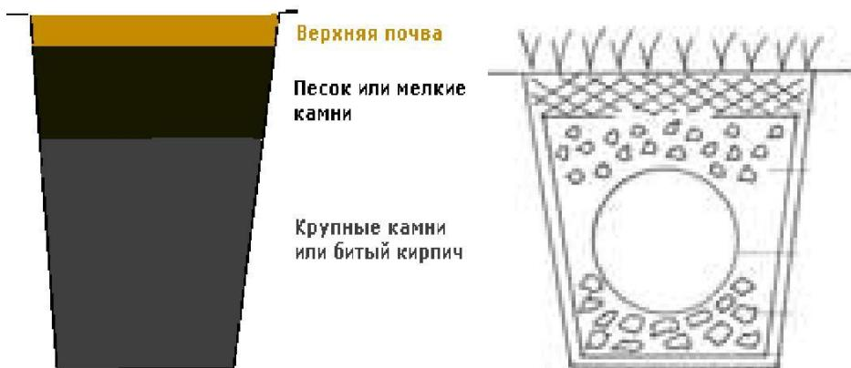
**Рис. 11. Устройство простейшей дренажной системы**
