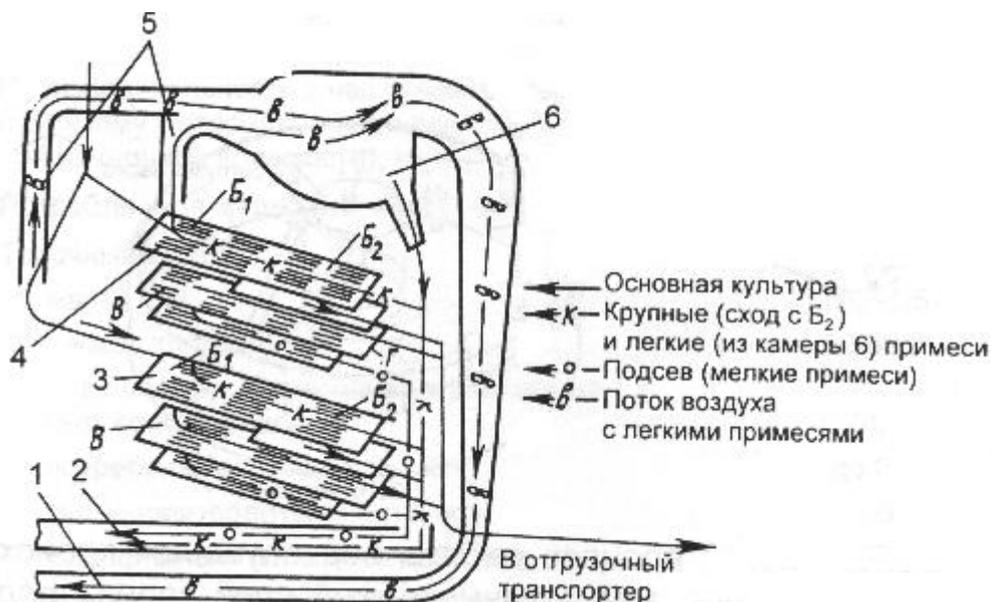
Рис. 50. Технологическая схема очистителя вороха ОВП-20А:
